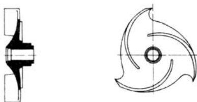
Fig. 2 Impeller type O
