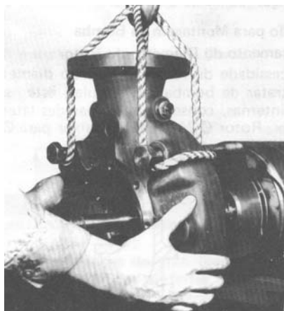
Figura 61 – Montagem do corpo de pressão (107)
