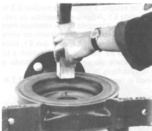
Figura 57 – Montagem do difusor do último estágio (171.1) no corpo de pressão (107)
