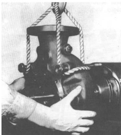
Figura 46 – Desmontagem do corpo de pressão (107)
