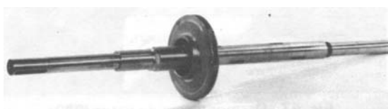
Figura 50 – Eixo (210) com rotor e luvas, já retirado do corpo de sucção
