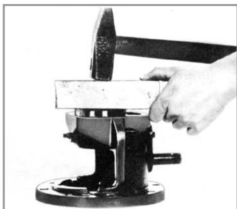
Fig. 50 - Montagem do rolamento (322) no corpo de mancal (350)
