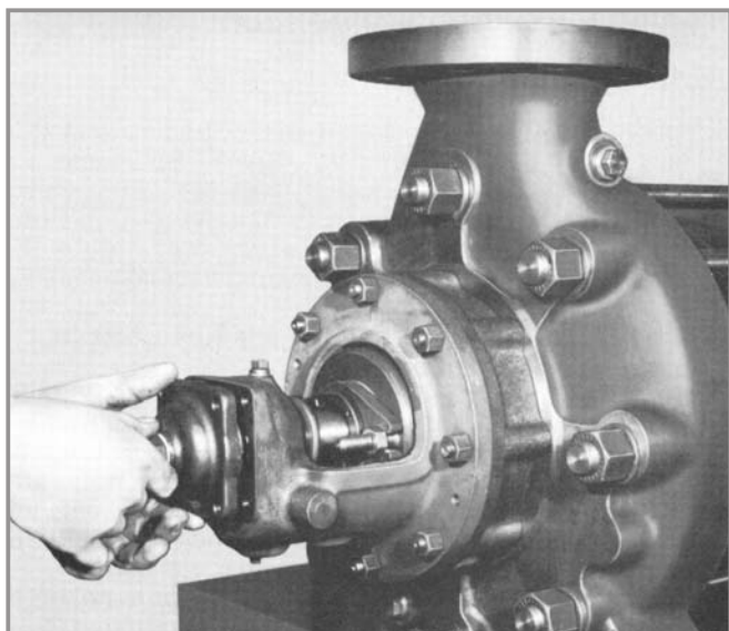
Fig. 58 - Montagem da tampa de mancal
